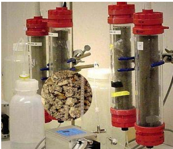
Figur 7. 2. Perkolationsstest - kolonner med diametern 5 cm.
