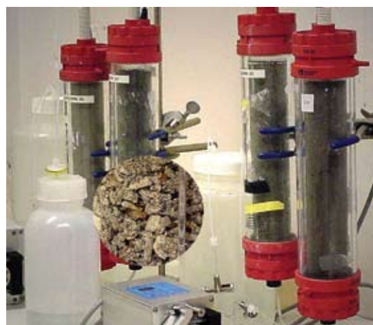
Figur 3. Perkolationsstest i laboratorium - kolonner med diametern 5 cm.
